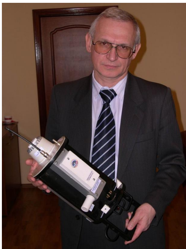
Рис.7. Макет первого российского наноспутника ТНС-0 в руках автора статьи
