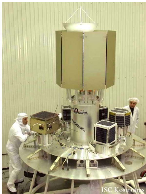
Рис.3. Размещение микроспутников на адаптере ракеты-носителя Днепр
